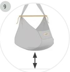
Überprüfe die richtige Höhe wie rechts beschrieben. Der Abstand zwischen Boden und Federwiege muss im leeren Zustand zwischen 50 und 60cm liegen.
